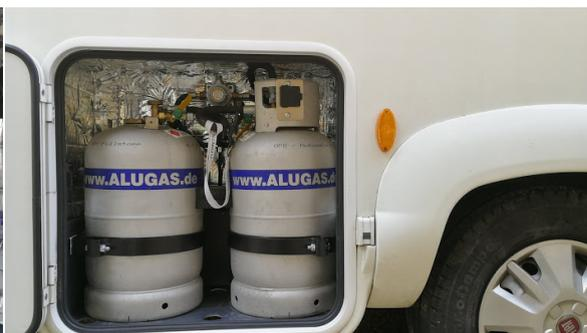
La fixation par l'arrière en mode "Sandwich" pour respecter la norme en vigueur qui précise la résistance à l'arrachement en cas d'accident et les sangles en métal pour rendre les bouteilles inamovibles, également afin de respecter la réglementation.
