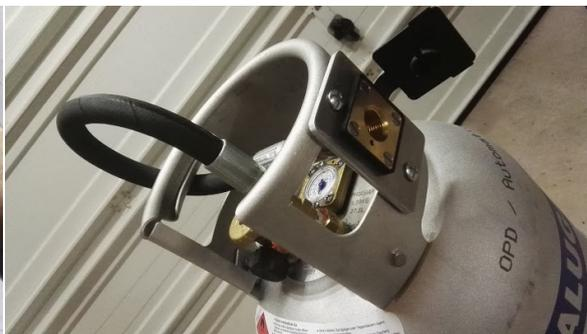
Le choix délibéré du remplissage par l'intérieur par soucis de discrétion, de réversibilité et d'étanchéité de la cellule. La sécurité n'étant pas remise en cause, car le remplissage s'effectue porte du coffre ouvert.
