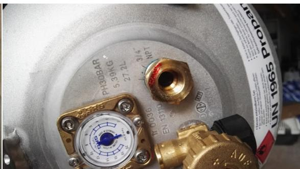
Avec l'inverseur de gaz, une seule bouteille nécessite vraiment la visualisation de la jauge, le support sur la première bouteille servant de fixation pour l'embout de remplissage.
